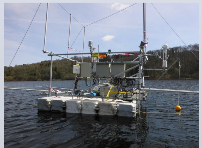
Hochfrequente Messung (10 Hz) von Gas-Konzentration und Luftbewegung. Liefert Dauermessung über große Flächen.
