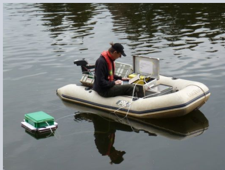
Direkte Fluxmessung an einer definierten Stelle. Erfassung räumlicher Unterschiede möglich.
